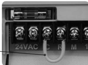
Schließen Sie statt der Drahtbrücke die beiden Kabel des Regensensors an. Die Polung ist hierbei gleichgültig. Stellen Sie den Regensensor-Schalter auf der Frontblende auf "ON".
